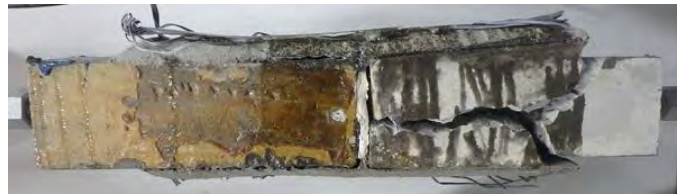
図 1.1.60 剥離後の様子
