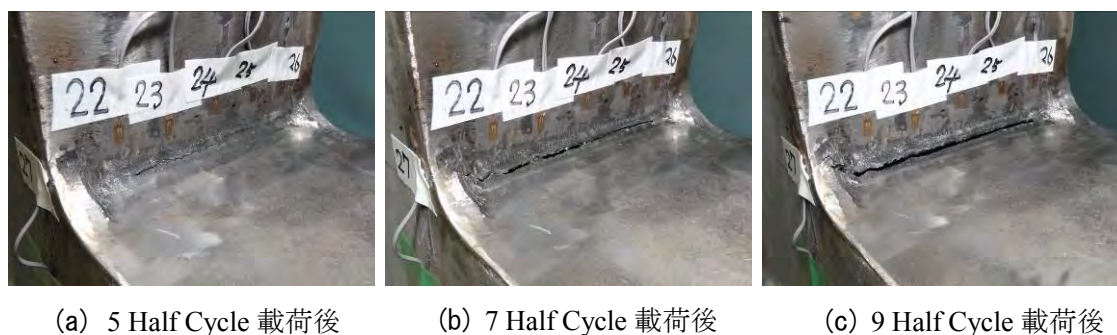
写真 1.1.11 S30-8-30-R-VC-NRG-2 のき裂進展過程
