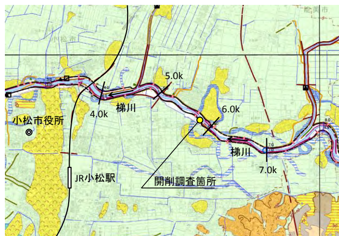
図 4.3.54 開削調査箇所周辺の微地形（地理院地図 治水地形分類図）
