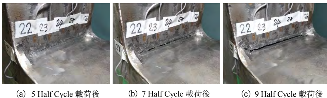
写真 1.1.11 S30-8-30-R-VC-NRG-2 のき裂進展過程
