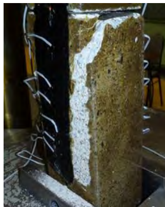
図 1.1.38 剥離の様子 (B-EP-40)
