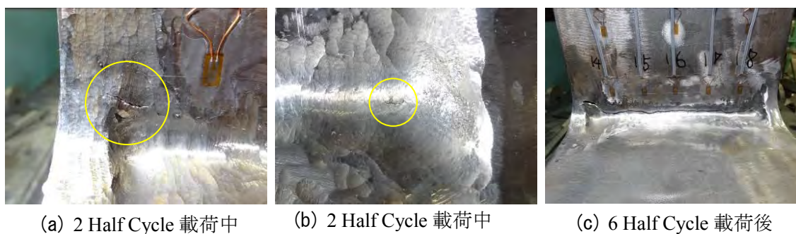
写真 1.1.12 S30-8-30-R-CC-NRG のき裂進展過程
