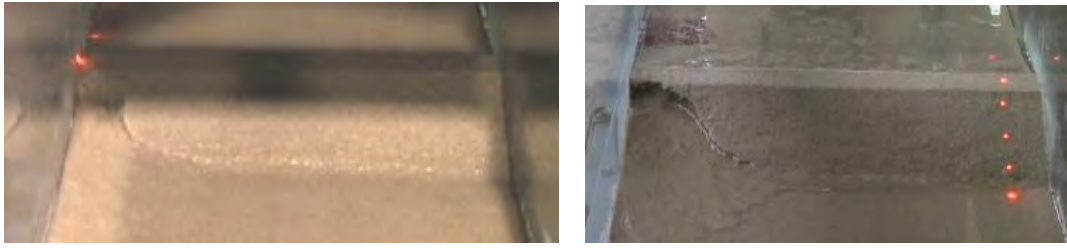
図 4.1.6 法面崩れの様子（左図：基盤設置幅 5cm, 右図：10cm）
