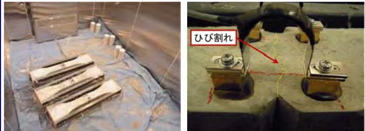
乾燥収縮による拘束ひび割れ試験実施風景
