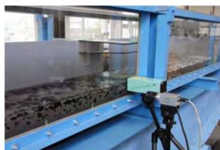
レーザーによる流れの可視化システム
