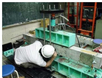
写真 2.4 補強効果確認実験の状況
