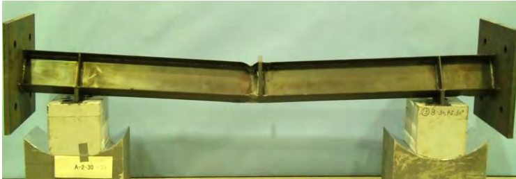
写真 2.1 最終変形状 (H-70×45×1.4×1.6, N/N_y=0.3 , 傾き 30°)
