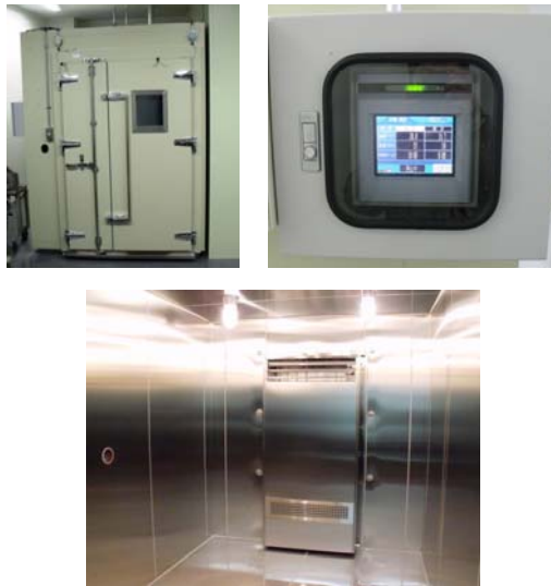
写真 2.1 劣化環境促進装置外観，操作パネル，および内装
