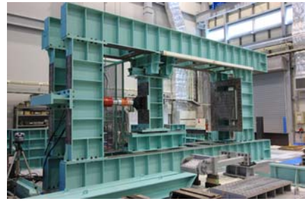
構造実験載荷システム
