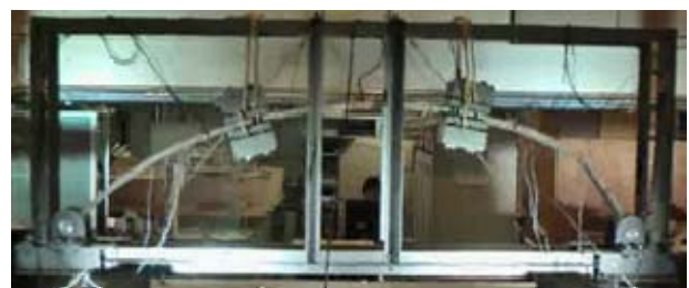
(a) 崩壊状況
