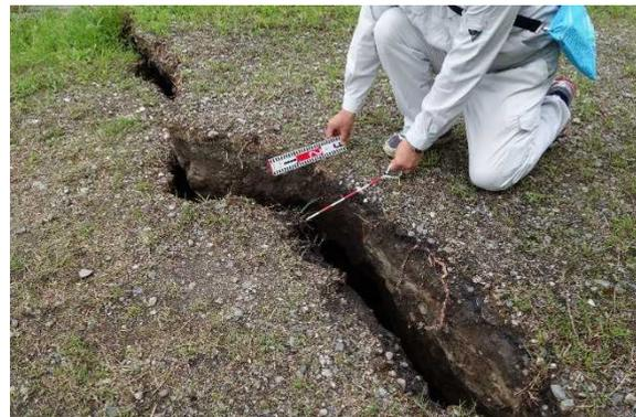
写真4.6 発生した幅20cm程度の亀裂
