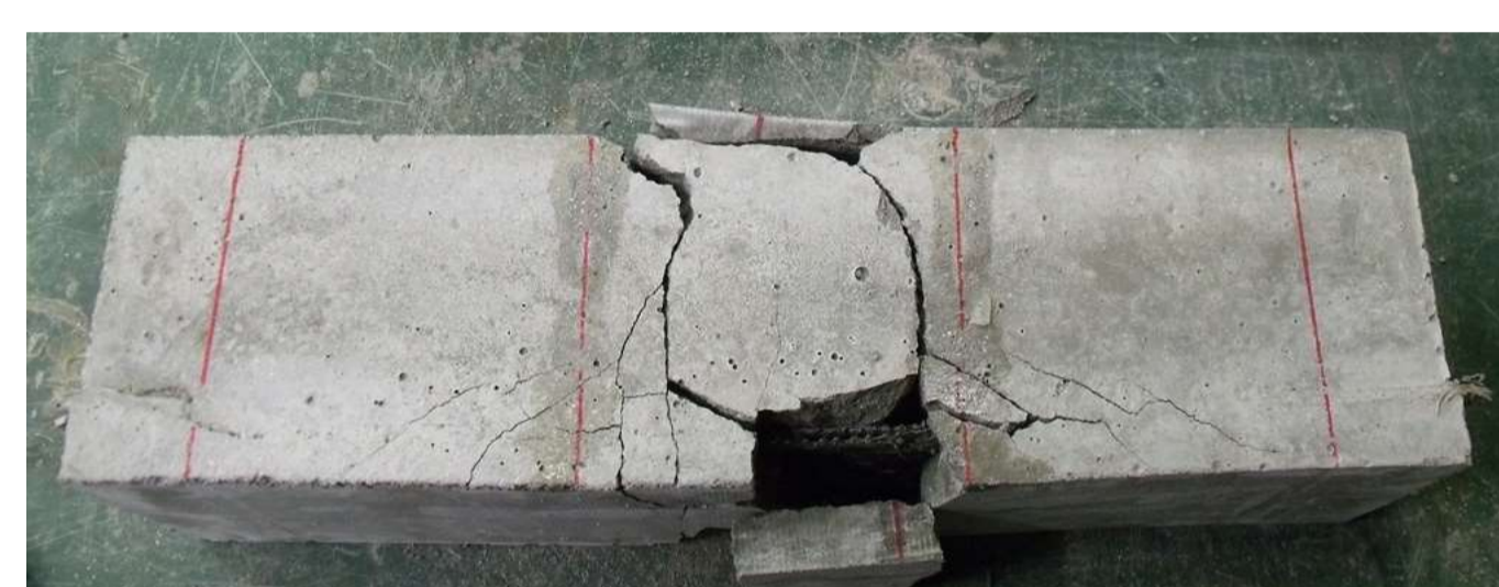
分散したひび割れの状況
