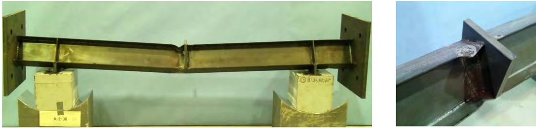
写真 2.1.1 最終変形状 (H-70×45×1.4×1.6,  $N/N_y=0.3$ , 傾き  $30^\circ$ )
