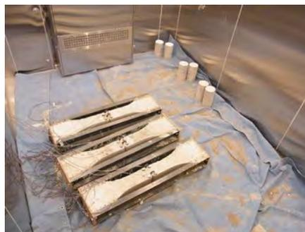
写真 2.2 乾燥収縮による拘束ひび割れ試験実施風景
