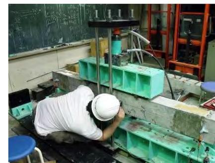
写真 2.4 補強効果確認実験の状況
