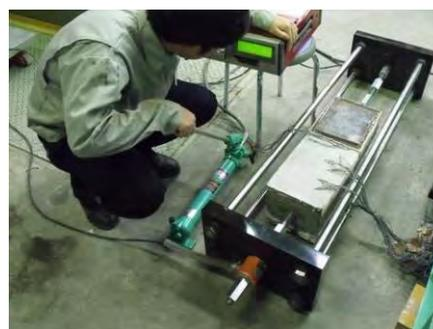
写真 2.3 付着強さ試験の状況
