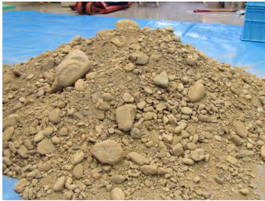
写真 5.3 液状化が懸念される砂礫地盤材料
