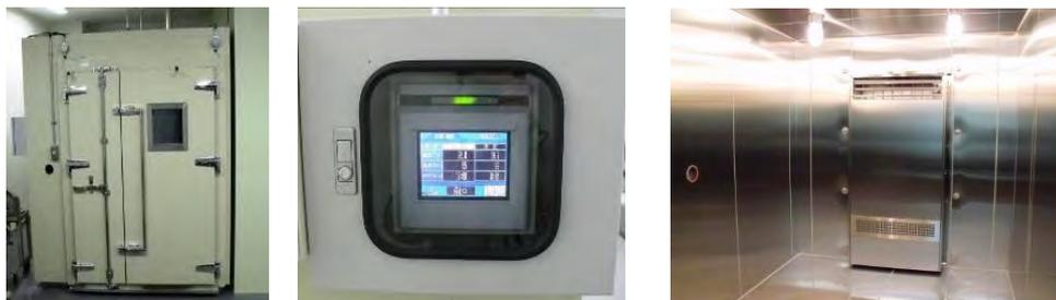
写真 2.1 劣化環境促進装置外観、操作パネル、および内装
